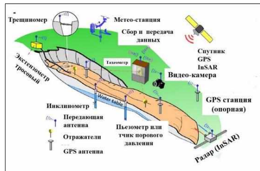
Система мониторинга на 20 оползнеопасных участках юга Кыргызстана
