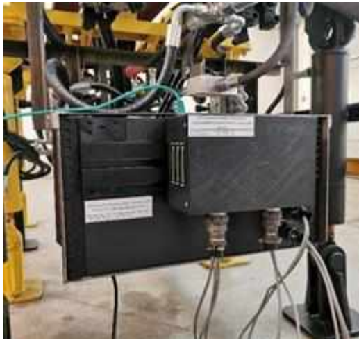
Рисунок 11 – Устройство управления электрогидравлической системой
