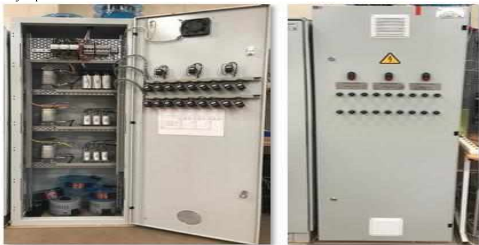
Рисунок 5 - Лабораторный пассивный фильтр гармоник
