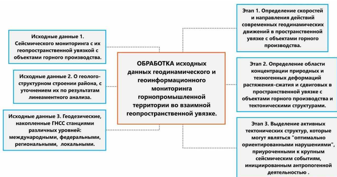
Рисунок 15 – Схема методического подхода к решению задачи накопления и обработки данных мониторинга горнопромышленных территорий
