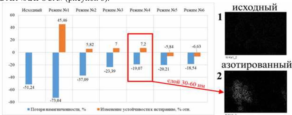
Рисунок 8 – Изменение устойчивости к истиранию (1) и намагниченности (2) образцов азотированного ферросилиция при интенсивном их взаимодействии в течение 7 дней с оборотной водой в исследуемых режимах
