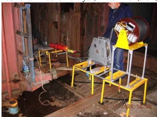
Рисунок 2 – Экспериментальные исследования в вертикальном стволе шахты им. Ф.Э.Дзержинского (ЛНР): a) аппаратура телеметрического мониторинга; б) обнаруженный водный поток в стволе
