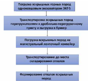
Технологическая схема ЦПТ для транспортировки вскрышных пород
