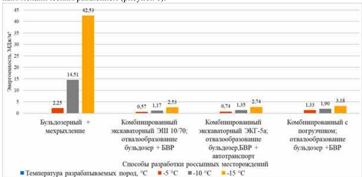
Рисунок 6 - Средняя энергоемкость вскрышных работ бульдозерным, комбинированными способами в зависимости от температуры разрабатываемых горных пород
