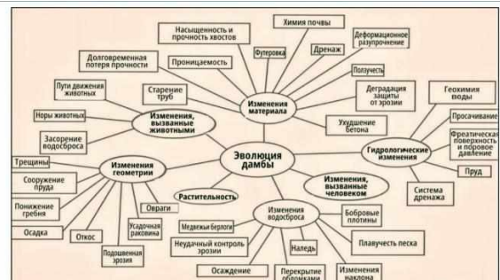
Эволюция дамбы хвостохранилища во времени в соответствии с мнениями экспертов
