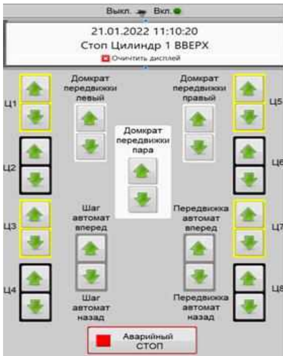
Рисунок 11 – Устройство управления электрогидравлической системой
