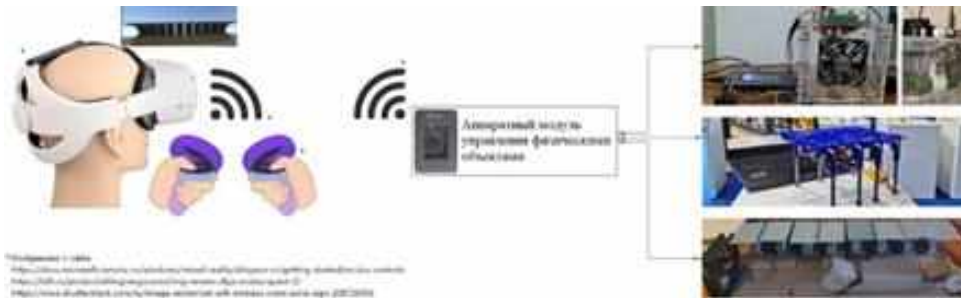
Рисунок 19 – Схема аппаратного взаимодействия элементов управления оборудованием из виртуальной реальности
